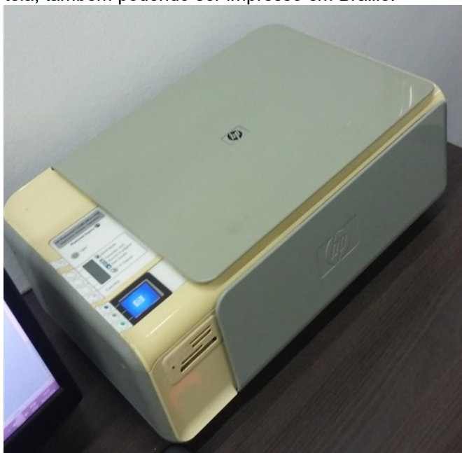
Figura 5 – Impressora da marca HP, modelo C4280, multifuncional. Utilizada para digitalização de documentos para adaptação, tais como livros e apostilas. Os documentos são convertidos, com software apropriado, em texto acessível aos leitores de tela, também podendo ser impresso em Braille.
