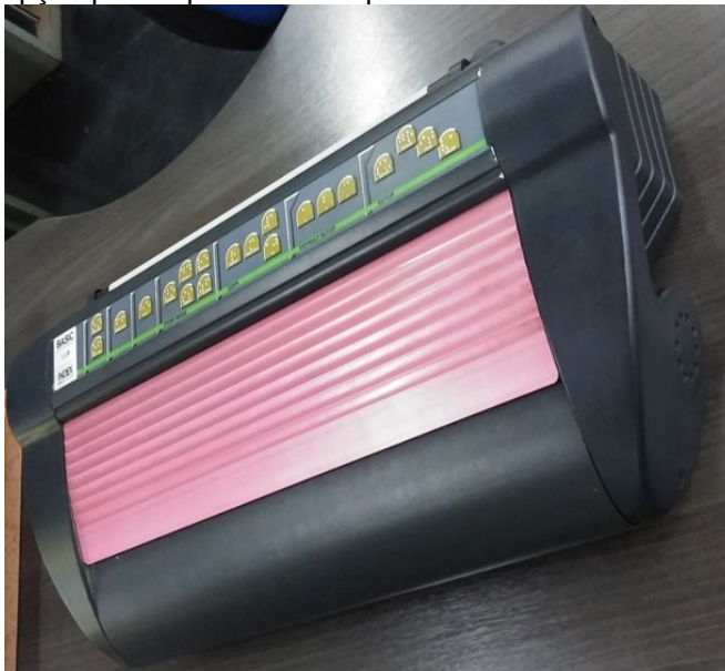
Figura 1 – Impressora Braille Index Basic. Utiliza papel de formulário contínuo de gramatura 120 a 180. Faz impressões em ambos os lados do papel, tendo a opção pela impressão em apenas um lado.
